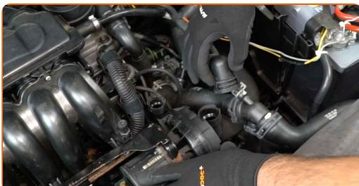
4 Pokrijte kanale sekundarne zračne črpalke s krpo iz mikrovlaken, da preprečite vstop prahu in umazanje v notranjost.
