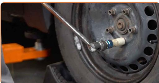
**4** Vzdignite sprednji del avtomobila in odprite podpornike.
