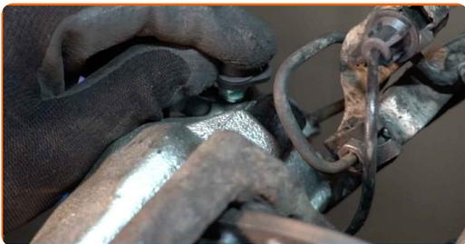
**34** Spustite sistem zavorne čeljusti. Brez zagona motorja pritisnite na zavorni pedal večkrat, dokler ne začutite odpor.
