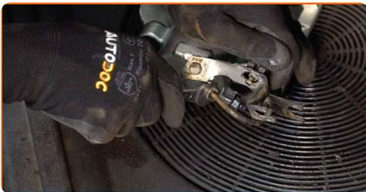
**22** Pričvrstite zavorne cevi na pritrdilni nosilec. Uporabite nasadni ključ №11. Uporabite izvijač z zatikalom.
