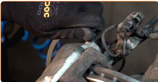
**37** Zategnite prezračevalni vijak sedlo zavore. Uporabite nasadni ključ №10. Uporabite navorni ključ. Zategnite ga do navora 9 Nm.
