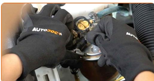
**15** Privijte pritrdilni element, ki povezuje cev za dovod goriva na ohišje filtra za gorivo. Uporabite nasadni ključ №7. Uporabite izvijač z zatikalom.
