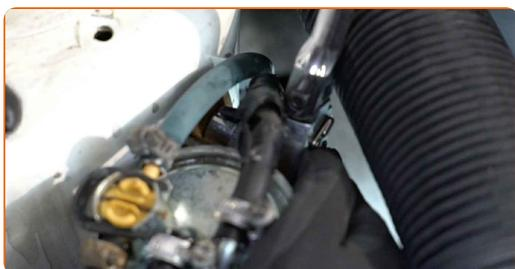
**5** Odstranite cevi za pritok goriva iz filtra za gorivo. Uporabite nasadni ključ №7. Uporabite izvijač z zatikalom.
