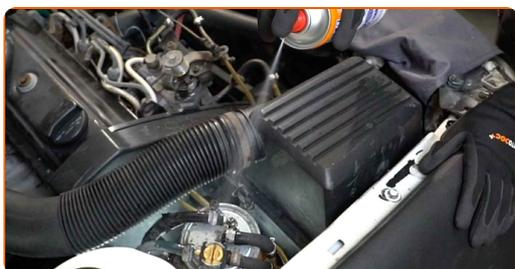
**4** Odvijte nosilec filtra za gorivo. Uporabite nasadni ključ №13. Uporabite izvijač z zatikalom.
