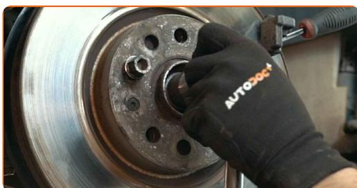
**17** Očistite nosilce zavornih čeljusti. Uporabite žično krtačo. Uporabite sprej WD-40.
