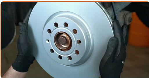
**58** Zategnite pritrditve zavornega diska. Uporabite vijačni nastavek T30. Uporabite navorni ključ. Zategnite ga do navora 4 Nm.
