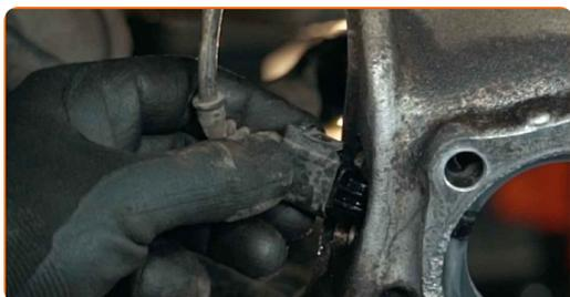
**42** Pričvrstite pritrdilni element, ki povezuje ABS-senzor s premnikom. Uporabite imbus št. H5. Uporabite navorni ključ. Zategnite ga do navora 7 Nm.
