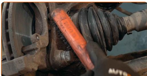
**18** Odvijte pritrditve nosilec čeljusti. Uporabite nasadni ključ №21. Uporabite izvijač z zatikalom. Uporabite udarni nasadni ključ.
