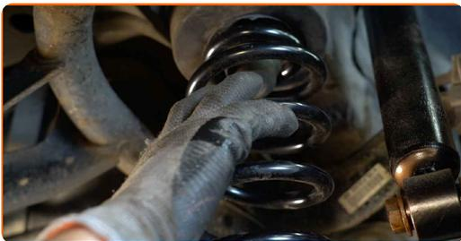
**17** Podprite ročico. Uporabite dvigalko s hidravličnim prenosom.
