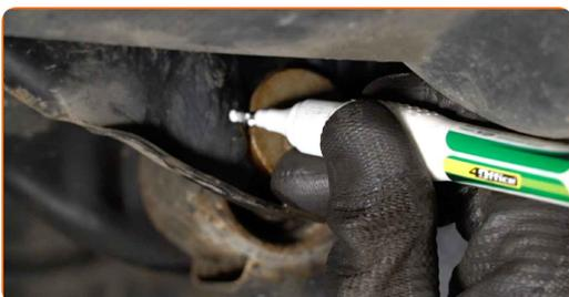
**8** Odvijte pritrdilni element ročice na drogu. Uporabite kombinirani ključ №18. Uporabite nasadni ključ №18. Uporabite izvijač z zatikalom.
