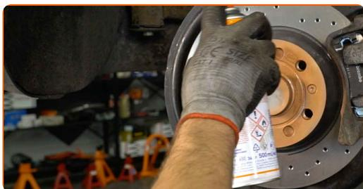
**27** Očistite površino zavornih kolutov. Uporabite čistilo zavor.
