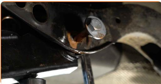
**19** Privijte pritrdilni element, ki povezuje vilice na zadnji pomožni okvir. Uporabite kombinirani ključ №18. Uporabite nasadni ključ №18. Uporabite izvijač z zatikalom.
