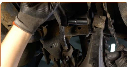
**9** Podprite ročico. Uporabite dvigalko s hidravličnim prenosom.
