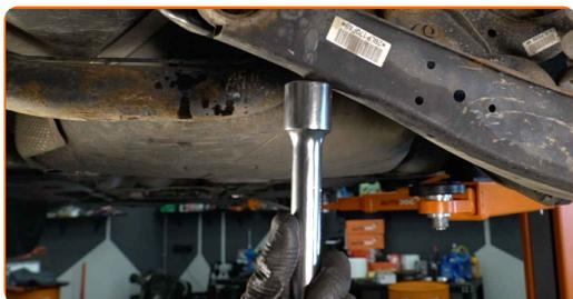
**10** Odvijte pritrdilni element, ki povezuje obeso koles z zadnjim premnikom. Uporabite kombinirani ključ №18. Uporabite nasadni ključ №18. Uporabite izvijač z zatikalom.
