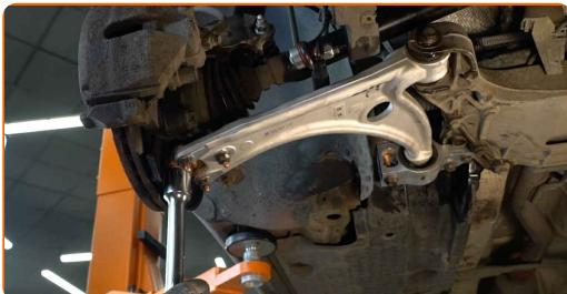
**27** Zategnite sprednji pritrdilni element, ki povezuje obeso koles s pomožnim okvirjem. Uporabite nasadni ključ №18. Uporabite navorni ključ. Zategnite ga do navora 70 Nm.+180°
