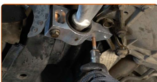
**25** Zategnite pritrdilne elemente nosilnega zgiba. Uporabite nasadni ključ №16. Uporabite navorni ključ. Zategnite ga do navora 60 Nm.
