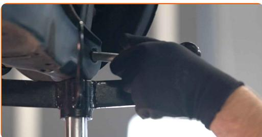
13 Spustite hidravlično dvigalo za menjalnik za 10-15 cm.
