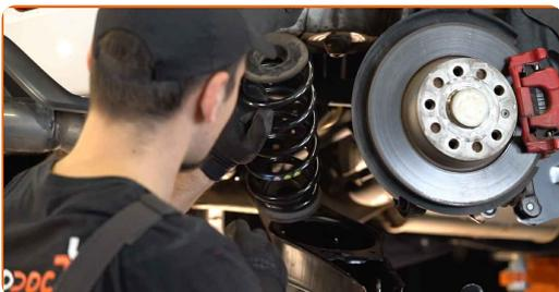
20 Podprite ročico. Uporabite dvigalko s hidravličnim prenosom.
