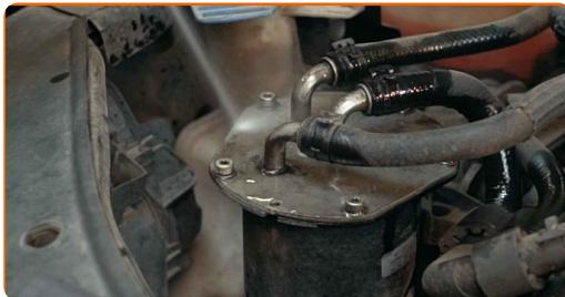
**4** Odvijte pritrtilne elemente pokrova ohišja filtra za gorivo. Uporabite vijačni nastavek T15. Uporabite izvijač z zatikalom.
