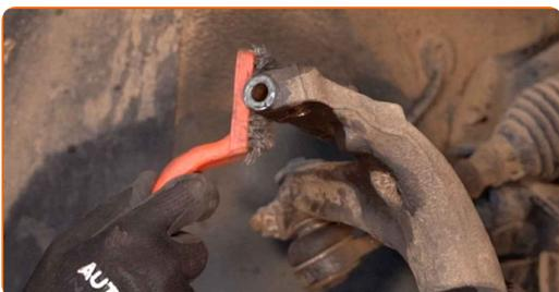
**56** Obdelajte vse dele prečnega vodila. Uporabite bakreno mast.
