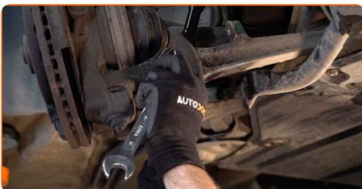
**55** Očistite nosilce in ležaje prečnega vodila. Uporabite žično krtačo. Uporabite sprej WD-40.
