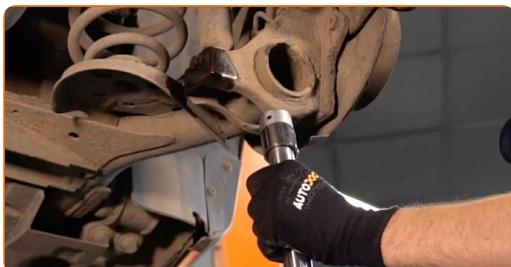
8 Odvijte spodnjo pritrditev amortizerja. Uporabite kombinirani ključ №16. Uporabite nasadni ključ №16. Uporabite izvijač z zatikalom.
