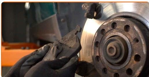
**14** Očistite nosilce zavornih čeljusti. Uporabite žično krtačo. Uporabite sprej WD-40.
