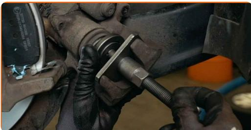
**33** Namestite zavorno čeljust in jo privijte. Uporabite kombinirani ključ №15. Uporabite nasadni ključ №13. Uporabite navorni ključ. Zategnite ga do navora 35 Nm.
