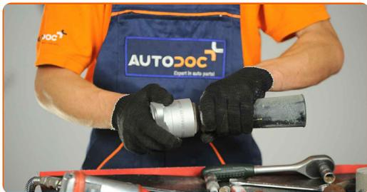
**17** Privijte zgornji pritrdilni element palice batnice opornika. Uporabite kombinirani ključ №17. Uporabite nastavljen ključ. Uporabite navorni ključ. Zategnite ga do navora 25 Nm.
