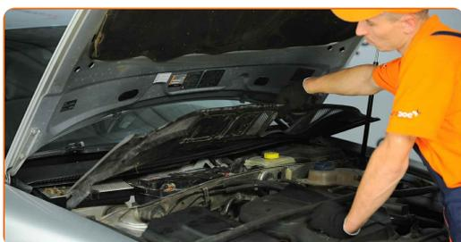
**14** Odstranite pokrov za namestitev blažilnika. Uporabite ploščat izvijač.
