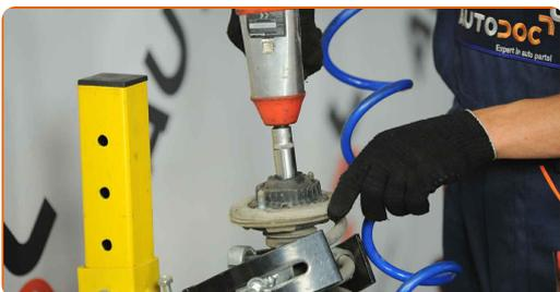
**21** Odstranite zgornji nosilec. Uporabite ploščat izvijač.
