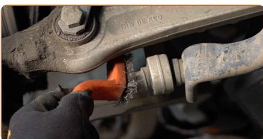
**7** Odvijte pritrdilni vijak, ki povezuje roke amortizerja s spodnjimi vilicami. Uporabite kombinirani ključ №18. Uporabite nasadni ključ №18. Uporabite izvijač z zatikalom.
