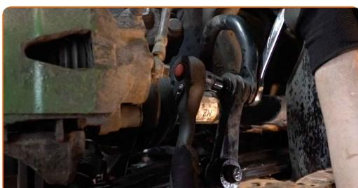
8 Odvijte pritrdilni element, ki povezuje drog stabilizatorja z vilicami. Uporabite nasadni ključ №16. Uporabite izvijač z zatikalom.
