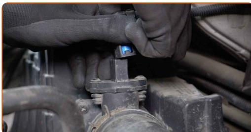
4 Odstranite vpenjalni kos cevi za dovod zraka. Uporabite klešče za objemke Clic-R.
