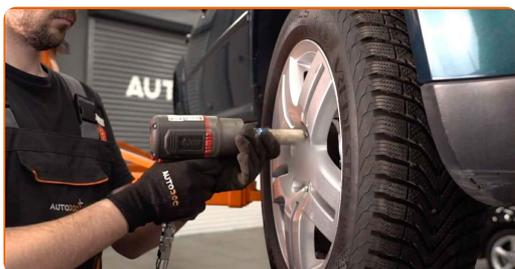
**23** Spustite avto in z delanjem v navzkrižnem vrstnem redu, zategnite kolesne vijake. Uporabite navorni ključ. Zategnite ga do navora 120 Nm.
