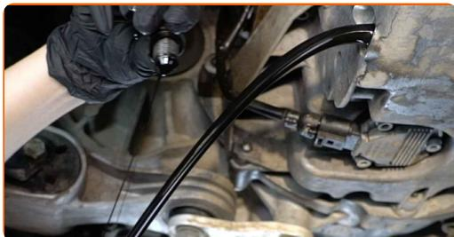
Menjava: olja in oljnega filtra – VW LT 28-46 II Keson / Podvozje (2DC, 2DF, 2DG, 2DL, 2DM). Nasvet:
