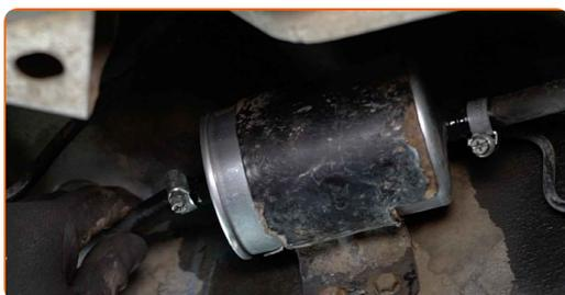
**19** Zategnite pritrdilne objemke cevi filtra za gorivo. Uporabite nasadni ključ №7. Uporabite izvijač z zatikalom.
