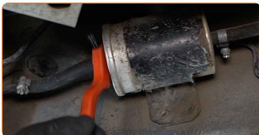
**9** Sprostite pritrdilne objemke cevi filtra za gorivo. Uporabite nasadni ključ N°7. Uporabite izvijač z zatikalom.
