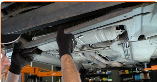
**22** Privijte pritrdilne elemente plastičnega zaščitnega pokrova karoserije. Uporabite nasadni ključ №10. Uporabite izvijač z zatikalom.
