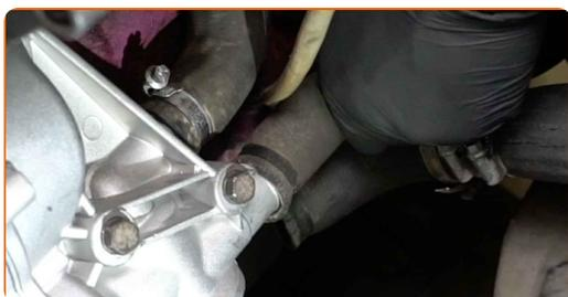
**28** Pritrdite sponko cevi hladilne tekočine. Uporabite nasadni ključ №7. Uporabite izvijač z zatikalom.
