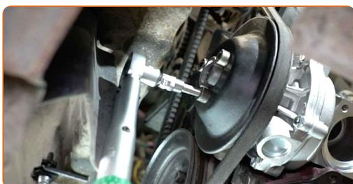
**34** Privijte pritrdilne elemente ohišja vodne črpalke. Uporabite nasadni ključ №10. Uporabite izvijač z zatikalom.
