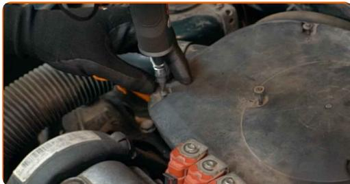
**4** Odstranite ohišje zračnega filtra.
