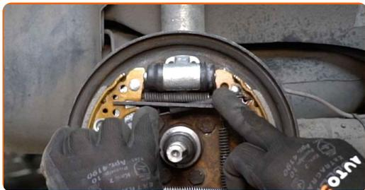
**27** Očistite nosilec ležaja pesta. Uporabite sprej WD-40.
