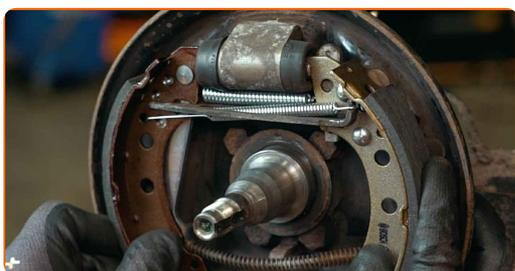
**26** Namestite držala čeljusti bobnastih zavor. Uporabite orodje za odstranjevanje varnostnih vzmeti zavorne čeljusti.
