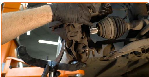
**26** Sprostite spodnji pritrdilni element, ki povezuje blažilnik s premnikom. uporabite poseben nastavek za nasadni ključ za odstranitev blažilnika. Uporabite izvijač z zatikalom.
