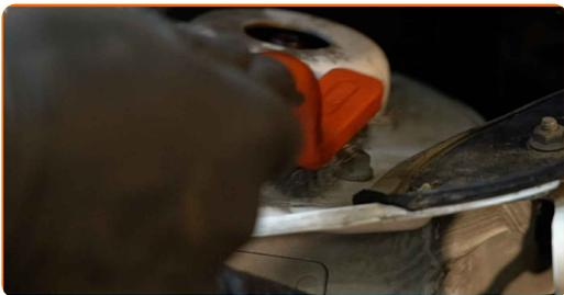
**6** Sprostite zgornji pritrdilni element sedeža za namestitev blažilnika. Uporabite nasadni ključ №13. Uporabite izvijač z zatikalom.
