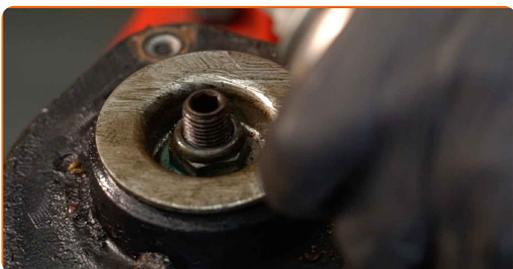
**33** Odstranite matico oporne batnice. Uporabite imbus št. H7. Uporabite nasadni ključ №21. Uporabite izvijač z zatikalom.
