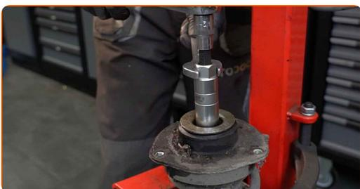
**34** Odstanite nosilec amortizerja, protiprašno zaščito in blažilec amortizerja.
