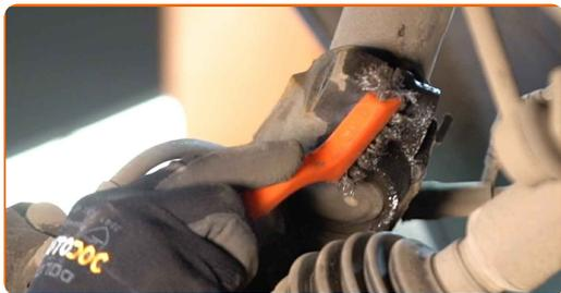
28 Sprostite spodnji pritrdilni element, ki povezuje blažilnik s premnikom. uporabite poseben nastavek za nasadni ključ za odstranitev blažilnika. Uporabite izvijač z zatikalom.
