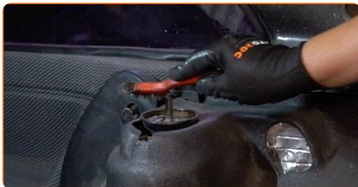
**3** Sprostite zgornji pritrdilni element sedeža za namestitev blažilnika. Uporabite kombinirani ključ №17. Uporabite nasadni ključ za blažilnik DDN№6. Uporabite izvijač z zatikalom.
