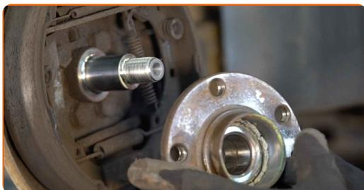
12 Očistite nosilec ležaja pesta. Uporabite večnamenski čistilni sprej.
