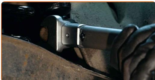
**39** Zategnite pritrdilni element spodnjega prečnega vodila. Uporabite kombinirani ključ №18. Uporabite nasadni ključ №18. Uporabite navorni ključ. Zategnite ga do navora 90 Nm.+90°
