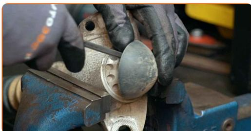
**21** Očistite pritrdilni element blažilnika v obliki palice. Uporabite žično krtačo. Uporabite sprej WD-40.
