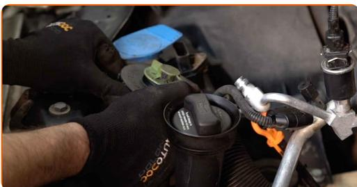
**7** Popustite objemko in odstranite zračno sesalno cev iz ohišja filtra. Uporabite kleščice za vodno črpalko.
