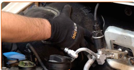
**4** Odstranite ohišje zračnega filtra kabine.
