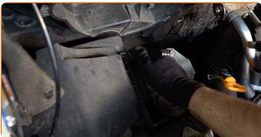
**9** Odvijte pritrdilne vijake ohišja filtra. Uporabite imbus št. H5.
