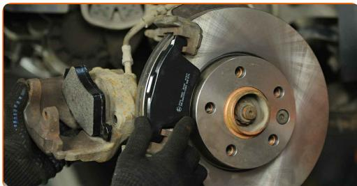
Menjava: zavornih ploščic – VW California T6 Minibus (SGC, SGG, SHC).
