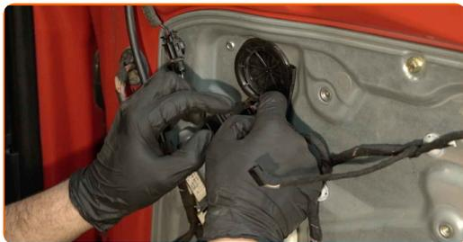
**53** Pritrdite kabel aktuatorja vratne ključavnice.
