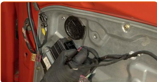
**52** Pritrdite konektor električnega okna na vratni panel.
