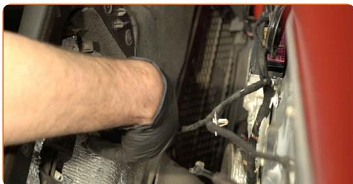
**11** Odstranite kabel aktuatorja vratne ključavnice.
