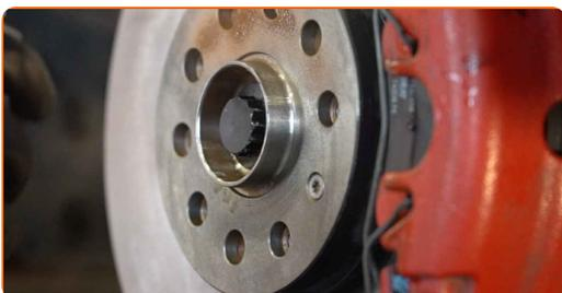
**21** Očistite površino zavornih kolotov. Uporabite čistilo zavor.
