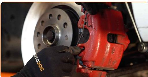
**20** Obdelajte površino, kjer se zavorni kolot stika s platiščem. Uporabite bakreno mast.
