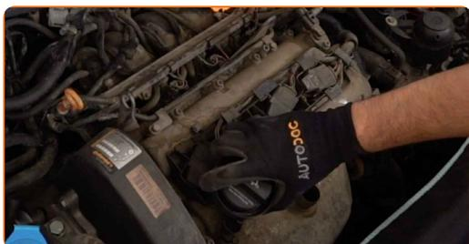
8 Pokrijte odprtino lijaka za nalivanje olja s krpo iz mikrovlakn, da preprečite vdor umazanije in tujkov v sistem.
