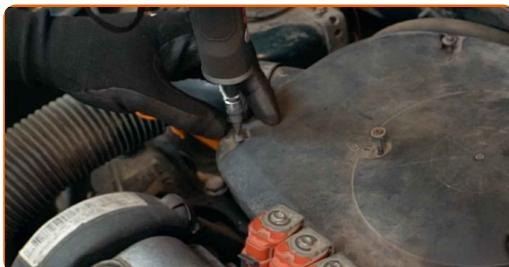
**4** Odstranite ohišje zračnega filtra.
