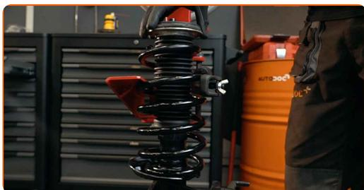
44 Namestite zgornji nosilec opornika in ležaj nosilca opornika.
