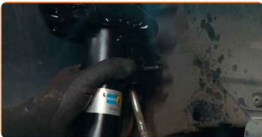
**66** Zategnite pritrdilni element, ki povezuje jarmov drog na blažilnik. Uporabite kombinirani ključ №18. Uporabite nasadni ključ №18. Uporabite XZN št. 6. Uporabite navorni ključ. Zategnite ga do navora 55 Nm.
