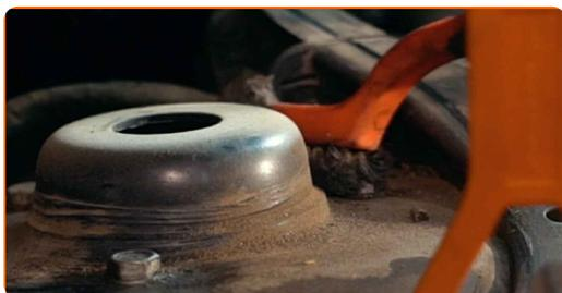
**7** Sprostite zgornje pritrdilne elemente vzmetne noge. Uporabite nasadni ključ №13. Uporabite izvijač z zatikalom.
