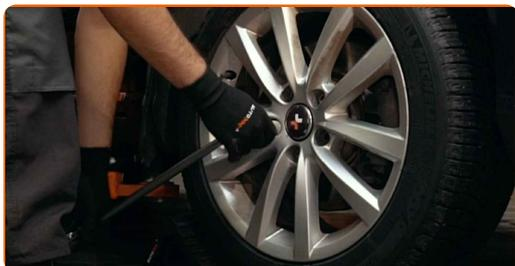
**10** Vzdignite sprednji del avtomobila in odprite podpornike.
