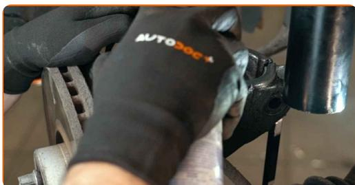
**53** Popravite opornik amortizerja na členku volana.
