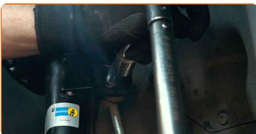
**67** Namestite in zategnite vijak pogonske gredi. Uporabite nasadni ključ №27. Uporabite izvijač z zatikalom.
