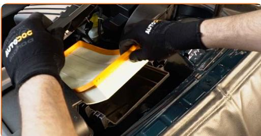
9 Pokrijte cev za dovod zraka s krpo iz mikrovlakn, da preprečite vnos prahu in umazanije v sistem.
