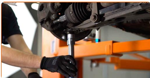
**17** Odvijte spodnji pritrdilni element, ki povezuje blažilnik s premnikom. Uporabite kombinirani ključ №18. Uporabite nasadni ključ №18.
