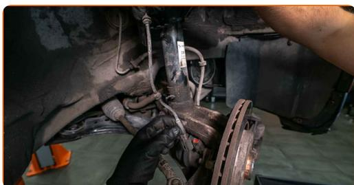
**48** Očistite nosilec platišča kolesa. Uporabite žično krtačo. Obdelajte kontaktno površino. Uporabite bakreno mast.
