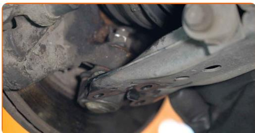
**45** Privijte pritrdilne elemente ploščice zgloba (3 deli). Pomembno! Prepričajte se, da boste uporabili nove pritrdilne elemente. Uporabite nasadni ključ N°13. Uporabite navorni ključ. Zategnite ga do navora 20 Nm.+90°
