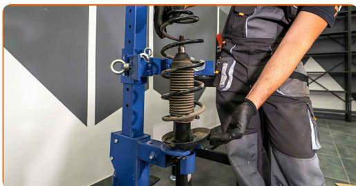
**29** Očistite nosilce spiralne vzmeti. Očistite drog amortizerja. Uporabite žično krtačo. Uporabite sprej WD-40.
