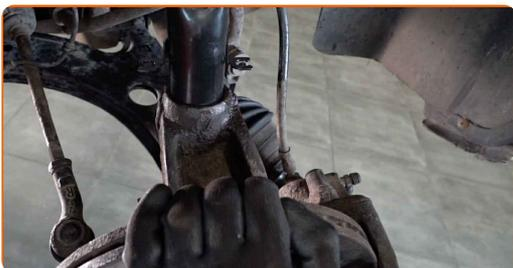
**40** Popravite opornik amortizerja na členku volana.
