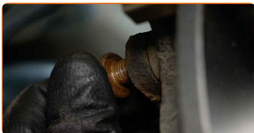
**29** Zategnite pritrdilne elemente nosilca zavornega sedla. Uporabite imbus št. H8. Uporabite navorni ključ. Zategnite ga do navora 65 Nm.
