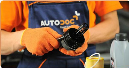
17 Namestite nov O-tesnilo na njegov nastavek na pokrovu oljnega filtra. Uporabite ploščat izvijač.
