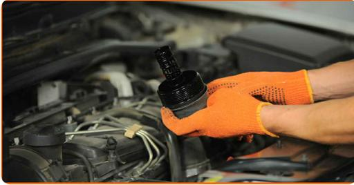
16 Odstranite O-tesnilo pokrova oljnega filtra. Uporabite ploščat izvijač.
