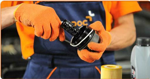
18 Namestite nov oljni filter na sedež za namestitev na pokrovu filtra.
