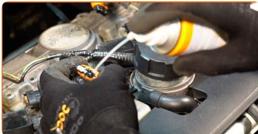
**22** Priključite priključke vžigalnih tuljav. Prepričajte se, da slišite klik, ki kaže na to, da je pravilno nameščena.
