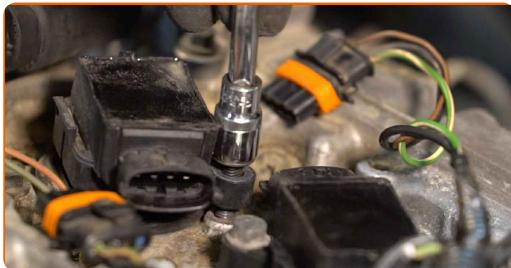
**21** Obdelajte konektor vžigalne tuljave s sprejem za elektroniko. Sprej bo zaščitil električne kontakte pred korozijo, oksidacijo in bo zmanjšal upor kontaktov.
