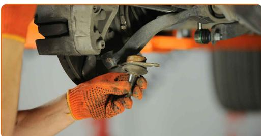
**13** Očistite sedež za namestitev nosilnega zgiba. Uporabite žično krtačo. Uporabite sprej WD-40.
