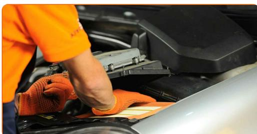
**11** Privijte pritrdilne vijake pokrova zračnega filtra. Uporabite vijačni nastavek T25. Uporabite izvijač z zatikalom.
