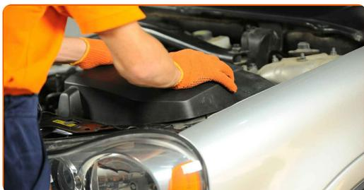
**13** Namestite pokrov motorja in ga pričvrstite.
