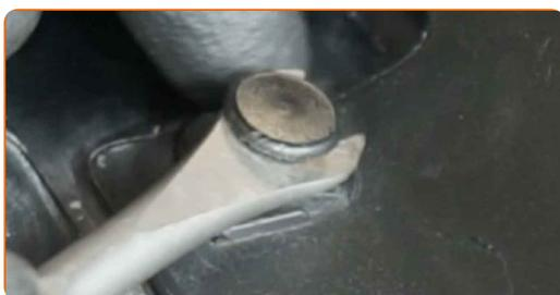
**4** Za dostop do pritrdilnih elementov nosilca vzmetne noge premaknite plastični panel pod okvirjem vetrobranskega stekla na stran.
