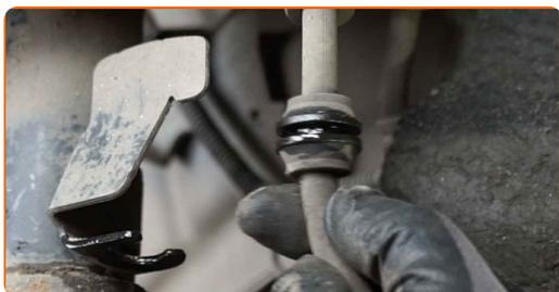
**14** Odklopite napeljavo ABS-senzorja.
