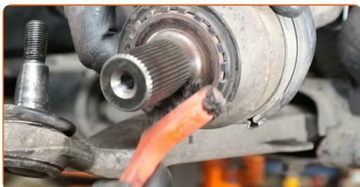
**53** Obdelajte ozobje pogonske gredi homokinetičnega zglobo. Uporabite bakreno mast.
