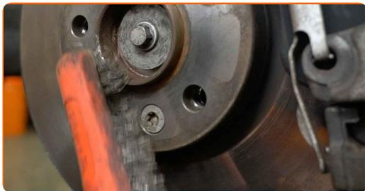
**73** Obdelajte površino, kjer se zavorni kolut stika s platiščem. Uporabite keramično pasto.
