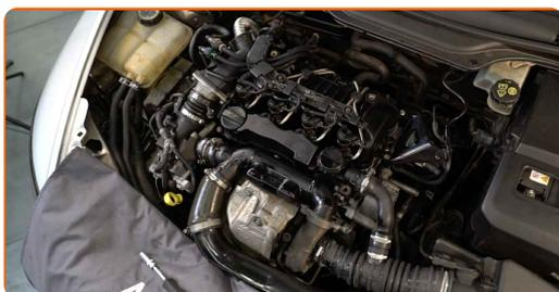
**4** Odvijte vijake nosilca filtra za zrak. Uporabite nasadni ključ №8. Uporabite nasadni ključ №10. Uporabite izvijač z zatikalom.
