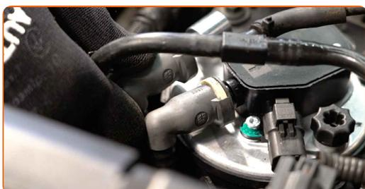
14 Privijte vijake nosilca filtra za gorivo. Uporabite nasadni ključ №8. Uporabite nasadni ključ №10. Uporabite izvijač z zatikalom.
