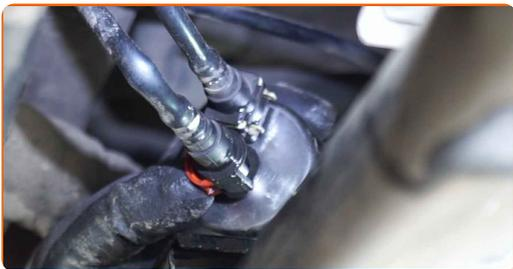
**13** Privijte namestitveni nosilec filtra za gorivo. Uporabite vijačni nastavek T30. Uporabite izvijač z zatikalom.
