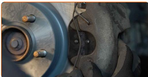
**27** Zategnite pritrdilne elemente zavorne čeljusti. Uporabite imbus št. H7. Uporabite navorni ključ. Zategnite ga do navora 28 Nm.
