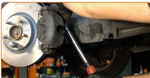
**28** Namestite pokrovice manšete vodilnih zatičev zavornih čeljusti.
