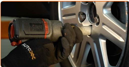
**33** Spustite avto in z delanjem v navzkrižnem vrstnem redu, zategnite kolesne vijake. Uporabite navorni ključ. Zategnite ga do navora 110 Nm.
