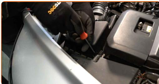
**4** Izključite konektor senzorja za masovni pretok zraka.
