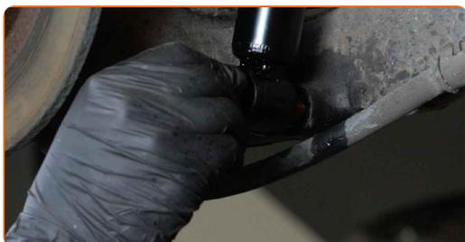
**18** Privijte spodnji pritrdilni element amortizer. Uporabite nasadni ključ N°E20. Uporabite izvijač z zatikalom.
