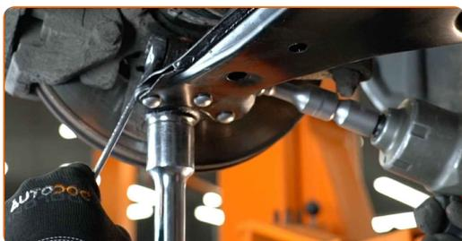
**23** Privijte pritrditev sprednje roke. Uporabite kombinirani ključ №18. Uporabite nasadni ključ №18. Uporabite udarni nasadni ključ.
