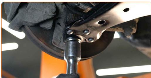
**22** Privijte pritrdilne elemente nosilnega zgiba. Uporabite kombinirani ključ №18. Uporabite nasadni ključ №18. Uporabite izvijač z zatikalom.
