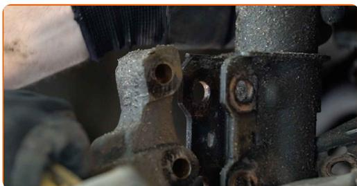
**15** Odvijte zgornjo pritrditev amortizerja. Uporabite kombinirani ključ №19. Uporabite nasadni ključ №9. Uporabite izvijač z zatikalom.
